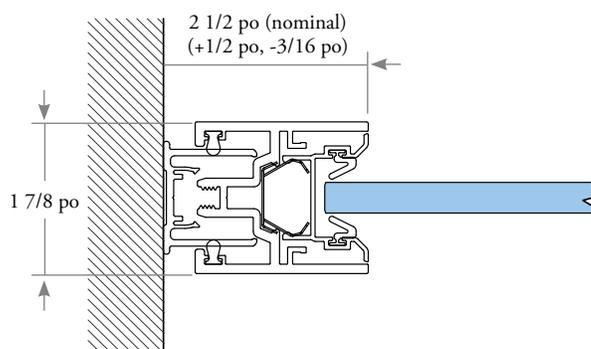
Ensemble de jambage Telescope simple (FQSGSJ)
